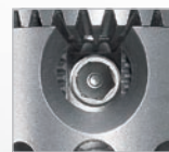
Sicherungsschraube einsetzen Inserting locking screw
